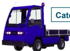
Chariot de manutention portant sa charge sur une plate-forme fixe ou sur un équipement non élévateur, dont la capacité de charge est inférieure ou égale à 2 tonnes.
