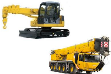
Grue automotrice à flèche télescopique qui peut être montée sur un mât (tour), capable de se déplacer en charge ou à vide sans avoir besoin de voie de roulement fixe et qui demeure stable sous l'influence de la gravité.
