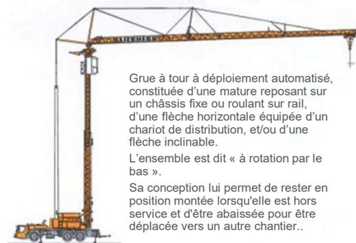
Grue à tour à déploiement automatisé, constituée d'une mât reposant sur un châssis fixe ou roulant sur rail, d'une flèche horizontale équipée d'un chariot de distribution, et/ou d'une flèche inclinable.
