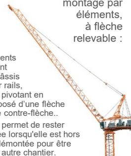
Grue à tour constituée d'éléments de mât, pouvant reposer sur un châssis fixe ou roulant sur rails, et d'un ensemble pivotant en partie haute composé d'une flèche relevable et d'une contre-flèche..
