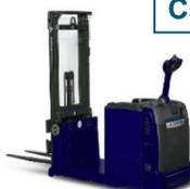
Chariot de manutention à conducteur porté équipé d'un mât fixe et muni de bras de fourche, pouvant élever une charge à une hauteur suffisante pour permettre son gerbage et son dégerbage, ou son stockage et son destockage en casier.
