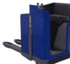
Chariot de manutention à conducteur porté muni de bras de fourche, pouvant élever une charge à une hauteur suffisante pour permettre son transport ou la préparation de commande au sol.
